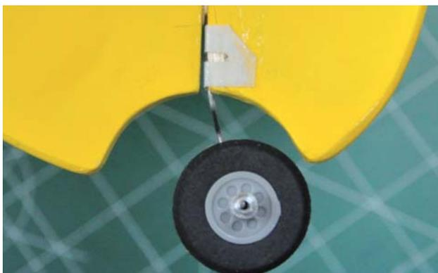
付属イージーヒンジを図のように折り曲げ、外角をカットしてラダーと尾輪のピアノ線を包むように中粘度瞬間接着剤で接着します。
