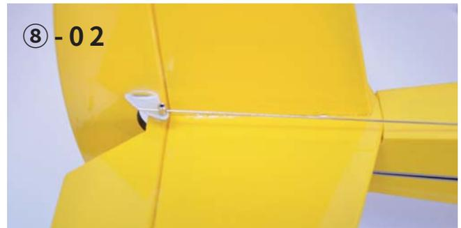
500ミリリフケーシングロッドのZ型に曲げられた方を各サーボホーンの外側から2番目の穴に取り付け、サーボ側からロッドを差し込みます。(サーボホーンを外した状態で作業してください)
