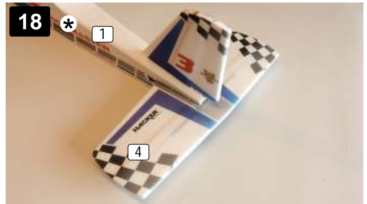
18 * Výškovku (4) zasunete do výezu v trupu (1). Trup p itom mírně roztáhněte. Dbejte, aby byla výškovka v trupu přesně usazena. Insert the elevator (4) into the slot in fuselage (1). Stretch apart a little the fuselage during inserting the elevator (4). Insert the elevator to the right position.
