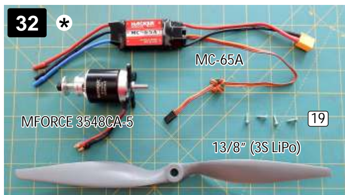
32 * Připravte si pohonnou jednotku (motor, regulátor). Motor připravte na tzv. „zadní montáž“. Pokud si konektory na motor a regulátor letujete sami pracujte pečlivě a kvalitně. Při letování konektoru baterie k regulátoru dbejte na správnou polaritu. Prepare the power set (motor, speed controller). Motor will be mounted in front of the firewall. If you solder the connectors on the motor and speed controller by your own make it carefully and well. Solder the battery connector to the speed controller with the correct polarity.
